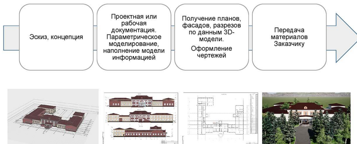
Рис. 8. Этапы разработки проекта с применением технологии информационного моделирования в рамках проектного института
